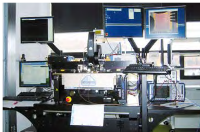
Spitzenmessplatz mit Netzwerkanalysator zur Charakterisierung von Halbleiterschaltungen.
