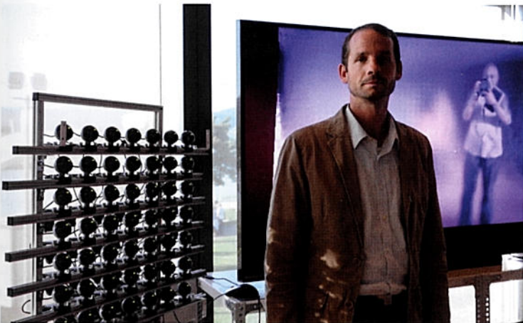
Lichtfeldfotografie: Prof. Dr. Oliver Bimber mit einem 7 x 7-Array. Die 49 Kameras entsprechen einem Objektiv mit einem Durchmesser von einem Meter, Foto: Dorothea Cremer-Schacht
