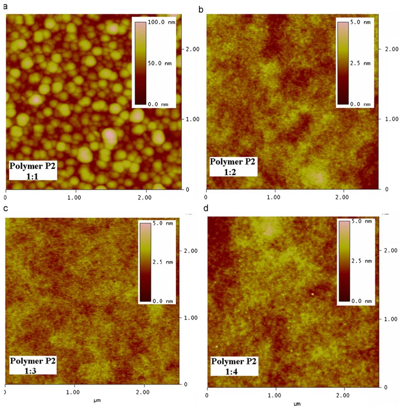
**Fig. 8.** AFM images of polymer **P2**:PCBM blend films for different wt ratios (a) 1:1, (b) 1:2, (c) 1:3, (d) 1:4.
