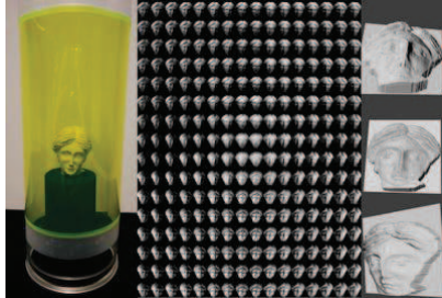
Folien 3D-Scanner, 256 gescannten Bilder und das 3D Modell
