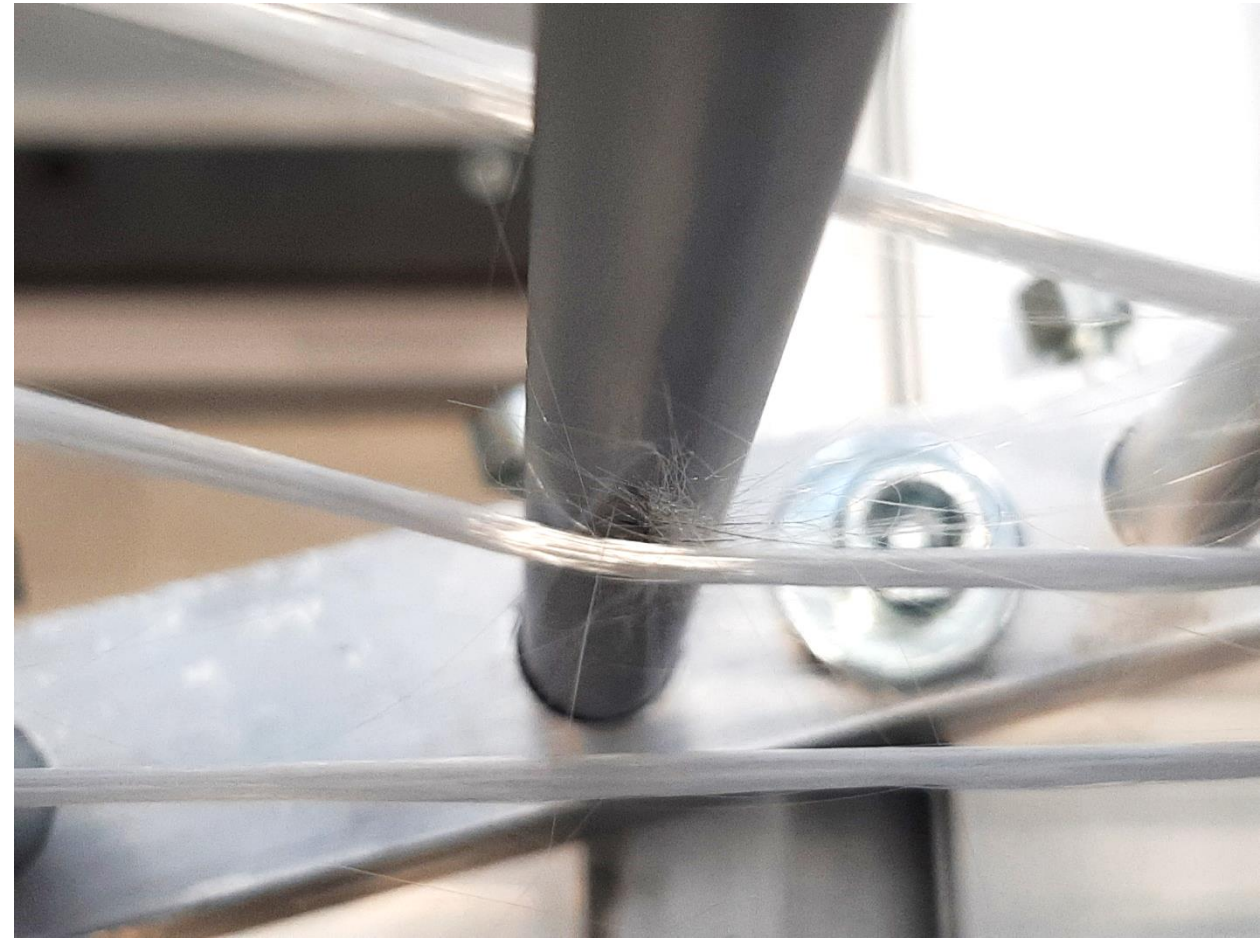
Faserbrüche bei Umlenkung
